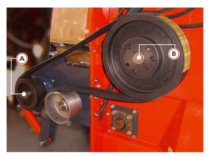
Emplacements des capteurs : poulie A et B
